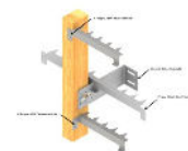
Het isolatiemateriaal bevestigen met de klauwen ABMI bevestigd op de hoekijzers ABC
